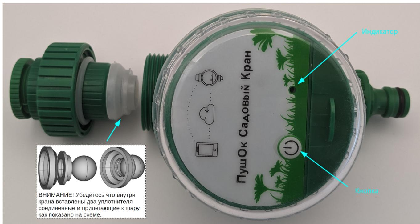
Открутите верхнюю крышку крана для доступа к кнопке. Нажмите и удерживайте кнопку. Светодиод загорится сразу при нажатии и через 5 секунд начнет мигать. Отпустите кнопку. При необходимости повторите. По завершении процедуры сопряжения плотно закрутите верхнюю крышку.
